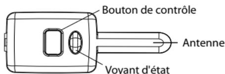
Le Centre de contrôle, généralement situé sur la partie supérieure du pare-brise envoie et reçoit des commandes ou des messages vers et à partir de votre système. Il est constitué de:
